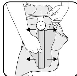
Zusätzlich kann das Gelenk frei über Klett auf der Velourfläche positioniert werden. Hierdurch kann individuell auf die Positionierung des Hüftgelenks eingegangen werden (z. B. Beugekontrakturen).
