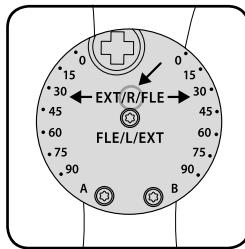
Nell'adattamento per il lato DESTRO dell'anca, la limitazione della flessione si trova sotto la dicitura "FLE" sul lato destro e la limitazione dell'estensione si trova sotto la dicitura "EXT" sul lato sinistro dell'articolazione.
