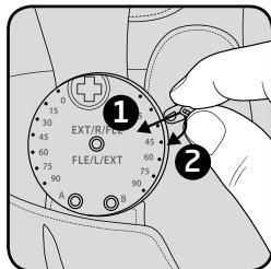
Beugungs- und Streckungsposition können in 0°, 15°, 30°, 45°, 60°, 75°, 90° limitiert werden. Die Keile werden senkrecht mit dem breiten Ende in die seitliche Verzahnung geschoben und durch Umlegen nach unten arretiert. Die Beschriftung A/B der Keile zeigt hierbei zu Ihnen. Stellen Sie sicher, dass der Winkelkeil in der gewünschten Gradzahl eingestellt ist.
