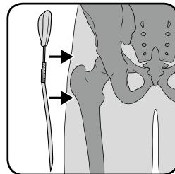
**5 / 6** Let er bij het aanpassen van de aluminium gewrichtsspalken op dat het scharnier in de looprichting van de patiënt verloopt. Wellicht is een aanpassing van het scharnierverloop zowel in het sagittale als het frontale vlak noodzakelijk. Dit kan worden gedaan met behulp van een afgerond buigijzer of handmatig door middel van zogenaamde 'koude vervorming'.
