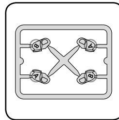
Um die Beugung und Streckung einzustellen, verwenden Sie den Keil mit der entsprechenden Kennzeichnung „A“ oder „B“. Diese Kennzeichnung entspricht der Kennzeichnung auf der Gelenkkappe. Platzieren Sie ihn unter der Kennzeichnung für Beugung „FLE“ um die Beugung und unter die Kennzeichnung „EXT“ um die Streckung zu limitieren.
