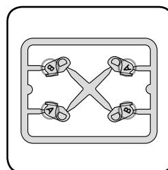
Pour régler la flexion et l'extension, utilisez la cale avec le repère correspondant « A » ou « B ». Ce repère correspond à celui figurant sur le cache de l'articulation. Placez-la sous le repère de flexion « FLE » afin de limiter la flexion et sous le repère « EXT », pour limiter l'extension.
