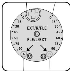
Voor het instellen van de flexie en de extensie gebruikt u de wig met de betreffende aanduiding 'A' of 'B'. Deze aanduiding hoort bij de aanduiding op de scharnierschijf. Zet deze onder de aanduiding voor flexie 'FLE' om de flexie en onder de aanduiding 'EXT' om de extensie te beperken.
