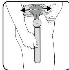
Verschieben Sie nun das Gelenk in horizontaler Richtung auf der Beckenspange. Dadurch kann das Orthesengelenk optimal an das anatomische Gelenk angepasst werden. Sobald die gewünschte Position erreicht ist, ziehen Sie die Schrauben wieder fest.
