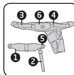
**1 / 2** Entfernen Sie die Beckenspange, inklusive Gelenk, indem Sie den unteren Gelenkschenkel (2) vom Klettverschlussbereich ablösen. Anschließend fädeln Sie die schmalen Gurte (3), die um die Beckenspange geführt sind, aus den Umlenkschlaufen (4) und Durchgangsschlaufen (5) der Beckenspange heraus.
