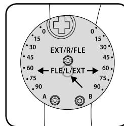
Bei der Anpassung für die RECHTE Hüftseite befindet sich die Begrenzung der Beugung unter der Kennzeichnung „FLE“ auf der rechten Seite und die Begrenzung der Streckung unter der Kennzeichnung „EXT“ auf der linken Seite des Gelenks.
