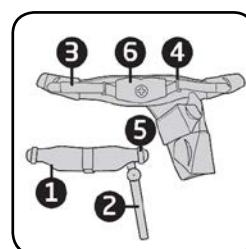
**1 / 2** Rimuovere il tutore pelvico, incluso lo snodo, staccando il braccio snodato inferiore (2) dalla zona della chiusura in velcro. Successivamente sfilare le cinghie sottili (3), che corrono intorno al tutore pelvico, dai passanti d'inversione (4) e dai passanti (5) del tutore pelvico.
