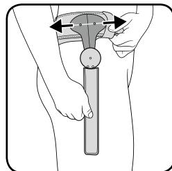
Nyní posuňte kloub ve vodorovném směru na pánevní sponě. Tím lze kloub ortézy optimálně upravit podle anatomického kloubu. Po dosažení požadované polohy opět utáhněte šrouby.
