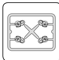
Pro nastavení ohybu a natažení použijte klín s odpovídajícím označením „A“ nebo „B“. Toto označení
