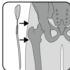
**5 / 6** Quando si adattano le stecche degli snodi di alluminio, prestare attenzione che lo snodo corra in direzione di marcia del paziente. Probabilmente sarà necessario adattare il posizionamento dello snodo sia sul piano sagittale sia su quello frontale. La regolazione può essere eseguita utilizzando leve per curvatura di forma arrotondata oppure manualmente mediante la cosiddetta deformazione a freddo.
