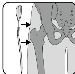
**5 / 6** Lors du réglage des attelles articulées en aluminium, veillez à ce que l'articulation aille dans le sens de la marche du patient. Il peut être nécessaire de régler le parcours de l'articulation, aussi bien dans le plan sagittal que dans le plan frontal. Ce réglage peut être effectué au moyen de crochets d'armoire arrondis ou à la main par déformation à froid.
