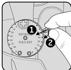
Polohu flexe a extenze lze omezit na 0°, 15°, 30°, 45°, 60°, 75°, 90°. Klíny se zasunou vertikálně širokým koncem do bočního ozubení a zajistí se sklopením směrem dolů. Nápis A/B na klínech směruje k vám. Ujistěte se, že je úhlový klín nastaven na požadovaný počet stupňů.
