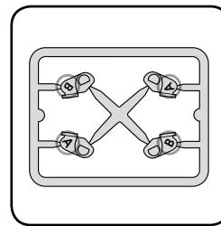
Para ajustar la flexión y la extensión, utilice la cuña con las marcas correspondientes «A» o «B», que corresponden a la identificación que incluye la tapa de la articulación. Coloque la cuña debajo de la marca de flexión «FLE» para limitar la flexión, y debajo de la marca «EXT» para limitar la extensión.
