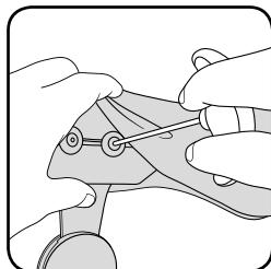
Svitare la vite di collegamento che unisce lo snodo dell'ortesi con il tutore pelvico. Tale vite di collegamento si trova sotto il rivestimento nel lato interno del tutore pelvico nella zona dello snodo.
