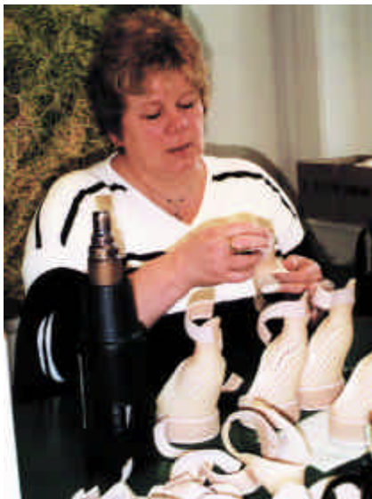
Noch ist vieles Handarbeit: Nach der thermoplastischen Zurichtung werden an der Orthese noch Klett- und Flauschbänder angebracht.
