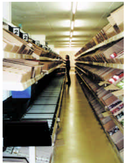
Logistisches Herzstück: die halbautomatische, scannerbasierte Kommissionieranlage.
